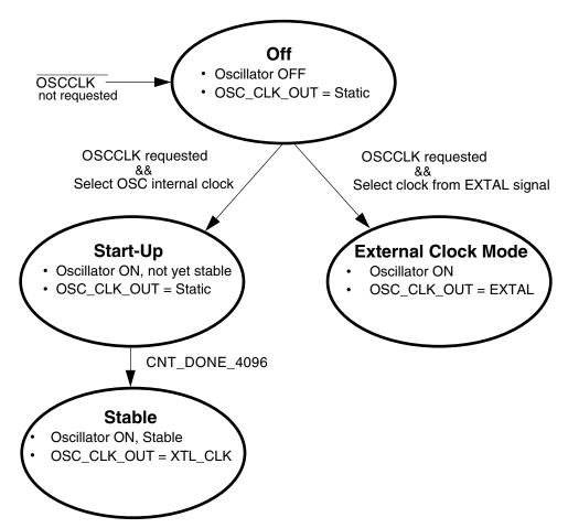
Figure 26-7. OSC Module State Diagram
