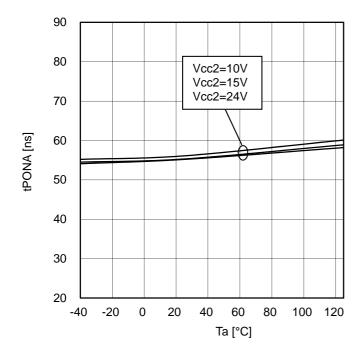
Figure 25. Turn ON Time (INA=PWM, INB=L)
