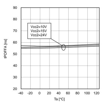
Figure 26. Turn OFF Time (INA=PWM, INB=L)
