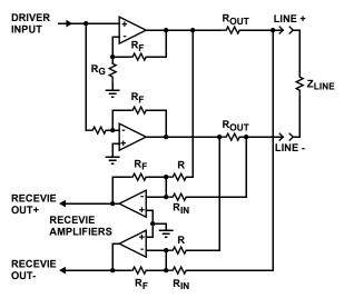
FIGURE 20. TYPICAL LINE INTERFACE CONNECTION
