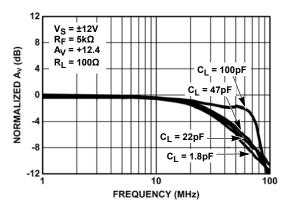
FIGURE 3. FREQUENCY RESPONSE FOR VARIOUS  $C_L$  (FULL POWER MODE)
