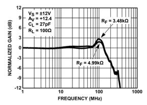
FIGURE 4. COMMON MODE FREQUENCY RESPONSE FOR VARIOUS  $R_{\rm F}$  (FULL POWER MODE)
