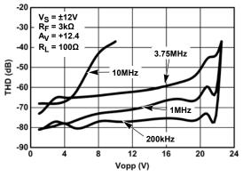
FIGURE 12. TOTAL HARMONIC DISTORTION FOR VARIOUS FREQUENCIES (FULL POWER MODE)
