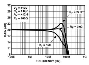
FIGURE 1. FREQUENCY RESPONSE FOR VARIOUS  $R_{\rm F}$  (FULL POWER MODE)
