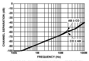
FIGURE 15. CHANNEL SEPARATION vs FREQUENCY
