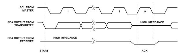
FIGURE 13. ACKNOWLEDGE RESPONSE FROM RECEIVER
