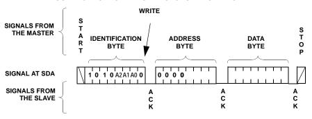
FIGURE 14. BYTE WRITE SEQUENCE
