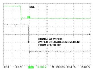
FIGURE 10. LARGE SIGNAL SETTLING TIME
