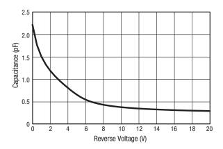
Figure 2. SMV2019-079LF Capacitance vs Reverse Voltage
