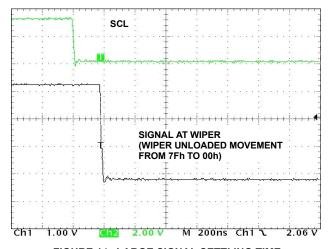
FIGURE 14. LARGE SIGNAL SETTLING TIME
