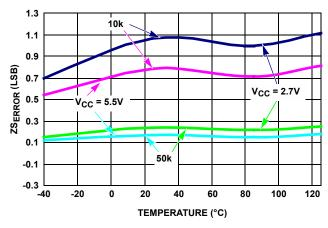
FIGURE 5. ZS<sub>ERROR</sub> vs TEMPERATURE
