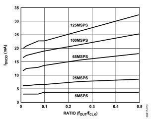
Figure 70.  $I_{DVDD}$  vs. Ratio @ DVDD1 = DVDD2 = 5 V
