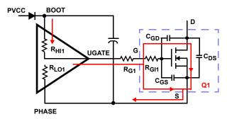
FIGURE 19. TYPICAL UPPER-GATE DRIVE TURN-ON PATH
